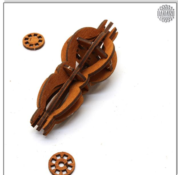
An die Enden der Nabe kommen nun die Teile eins und vier. Die Teile unterscheiden sich durch das Loch in der Mitte. Das Teil 1 ohne dem Loch gehört an die Spitze der Nabe und das Teil 4 mit dem Loch an das untere Ende der Nabe.
