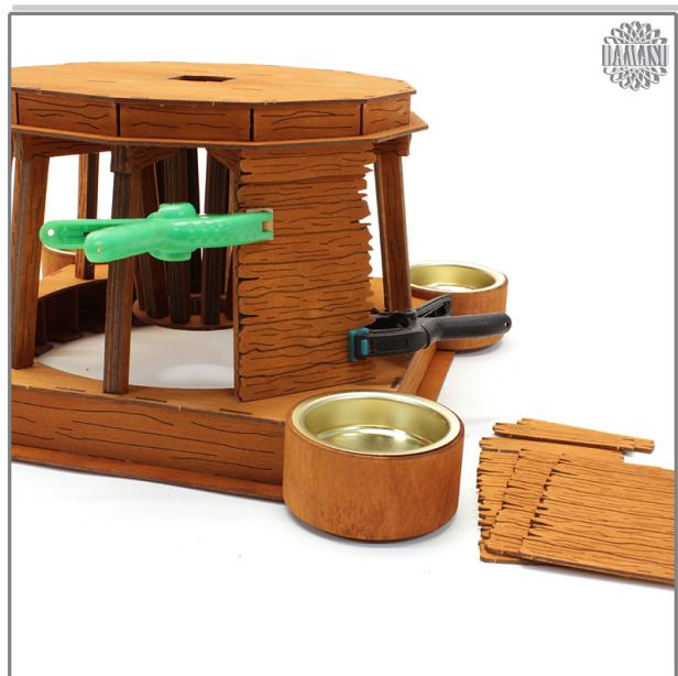
Wenn Sie die Möglichkeit haben, dann können Sie die Platten zum Trocknen etwas anklammern. Das kleinere Brett wird darüber angeleimt.
