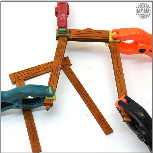
Auf die Mittelteile leimen Sie dann die Außenteile mit der Gravur nach außen. Die seitlichen Stempel sind unterschiedlich lang. Achten Sie darauf, dass die Teile deckungsgleich zu den Mittelteilen aufgeleimt werden.
