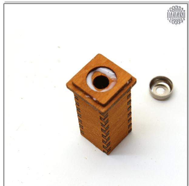
In die Öffnung wird die Blechführung mit der Wölbung nach oben geleimt.
