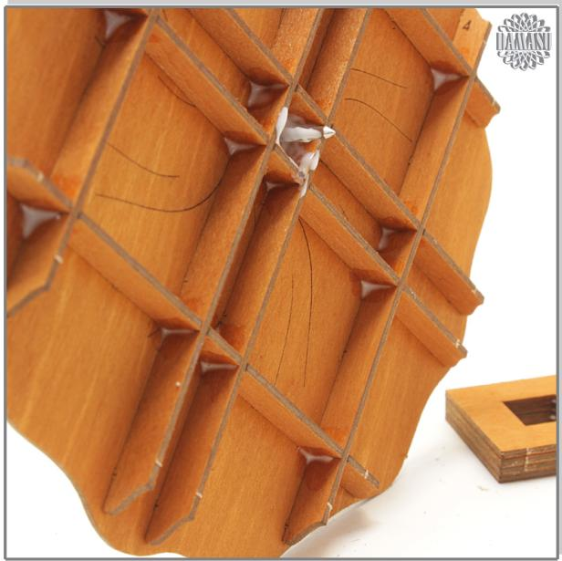
In dieser Position leimen Sie die Achse von beiden Seiten des Pyramidentellers fest. Achten Sie dabei auf die Spitze der Achse. Diese darf nicht mit Leim verschmutzt werden.
